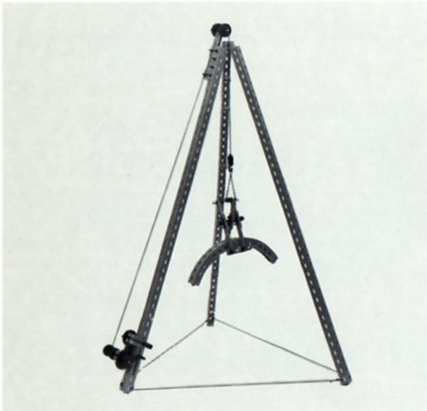
Abb. 23: Modell eines einfachen Hebezeugs. Dreibock mit Seilwinde und Greifer.
